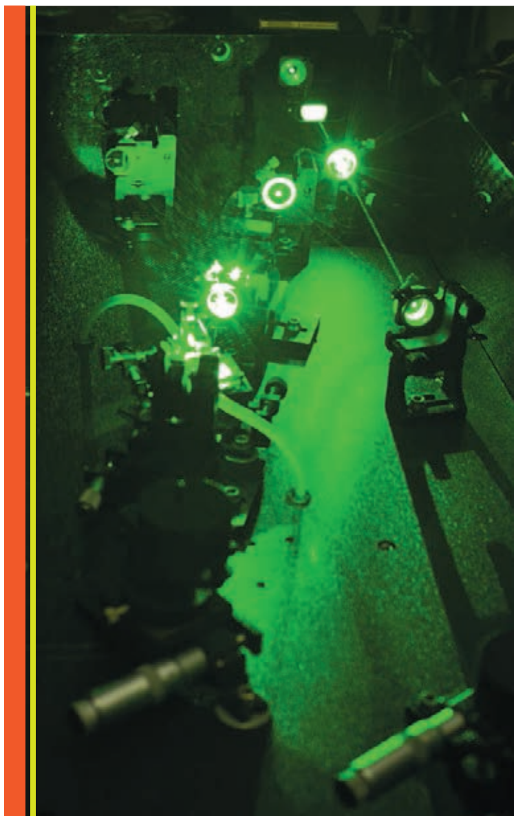
Установка для анализа оптических свойств высокоупорядоченных сопряженных полимеров и углеродных материалов при помощи фемтосекундной спектроскопии методом накачки-зондирования
