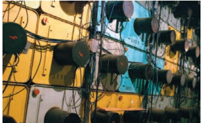
Сцинтилляционные счетчики, регистрирующие нейтрино в Баксанской нейтринной обсерватории
