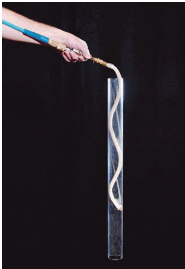
Такие гидростатические устройства, как это, служат прототипами роботов-змей
